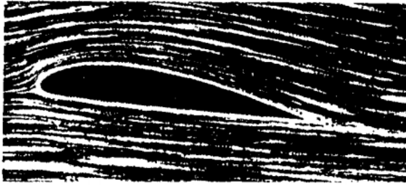
Rys. 7. Opływ ciała stałego o aerodynamicznym kształcie [79]
